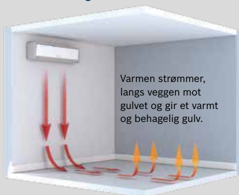
Varmluftfordeling i varmedrift for å forhindre trekk
