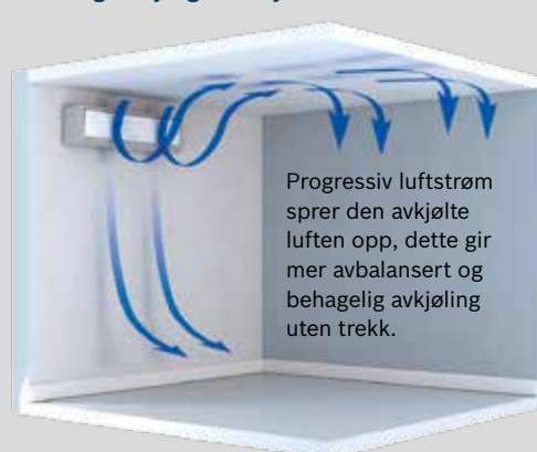
Fordeling av kjølig luft i kjøledrift
